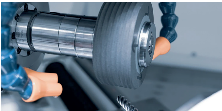
34 Projektabschluss – Herstellung von Hartmetallwerkzeugen durch kontinuierliches Wälzschleifen
