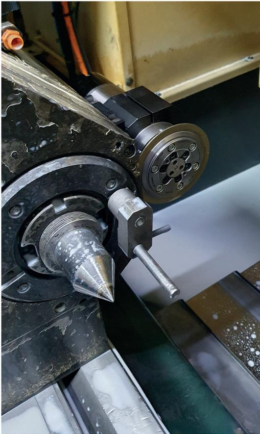
Effizienzsteigerung bei älteren Maschinen: Abrichtspindel nachgerüstet am Werkstückspindelstock
